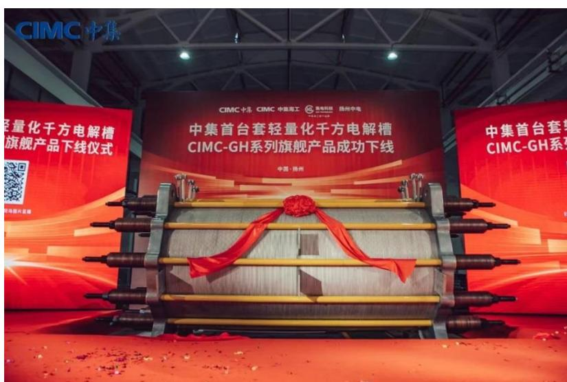
完成新型轻量化千方电解槽 CIMC-GH 系列旗舰产品下线，实现单位产氢量 1200Nm<sup>3</sup>/h（平均小室电压 2V），电解槽槽体重量 39.8 吨，较常规千方碱槽减重 20-30%。代表着中集正式进入规模化绿电制氢赛道，中集将以中集集电为核心载体，从陆上规模制氢场景向海上制氢场景延伸。以本次成功下线的 CIMC-GH 系列为基石，中集集电将持续研发更高效、更集约、更高产的电解槽产品。
